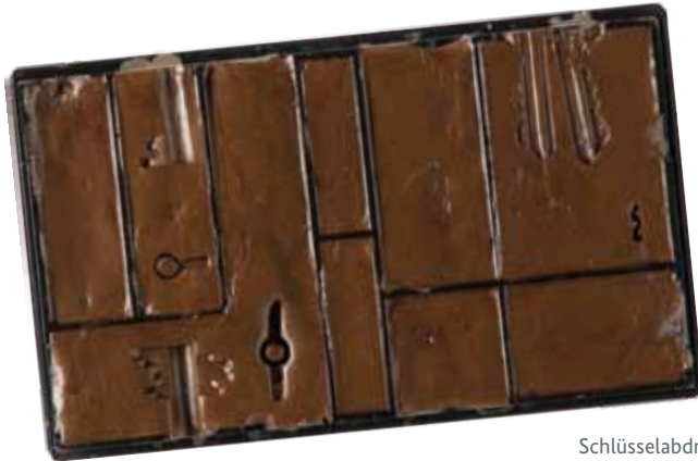
Schlüsselabdruckkasten der Stasi: Mithilfe eines solchen Kastens fertigte die Stasi Schlüsselkopien an, um heimlich in Wohnungen eindringen zu können
