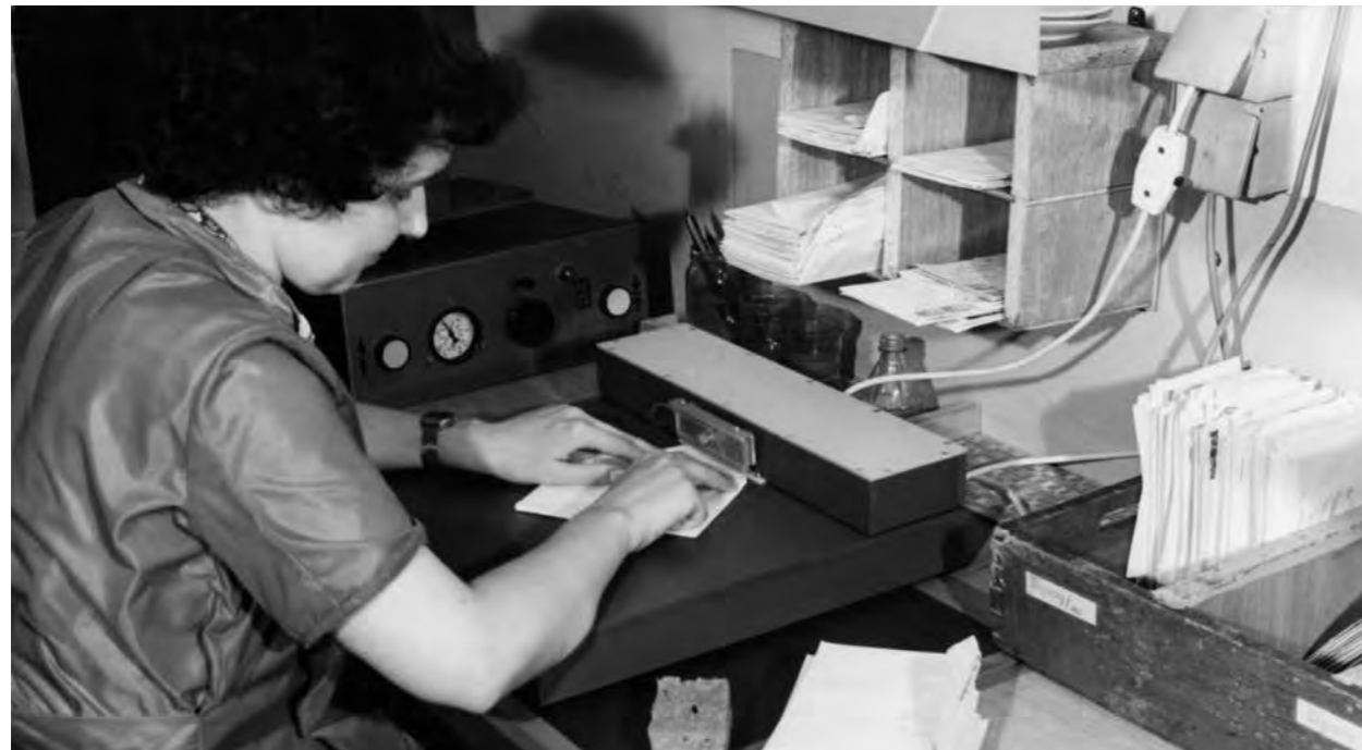
> 1986 entwickelte das MfS ein halbautomatisches Gerät zum Verschließen geöffneter Postsendungen. »Die »HSM 86« wird unseren Anforderungen gerecht«, befanden die sächsischen Postkontrolleure. 1987 BSTU, MfS, BV Karl-Marx-Stadt, Abt. M, Nr. 4, Bl. 20
